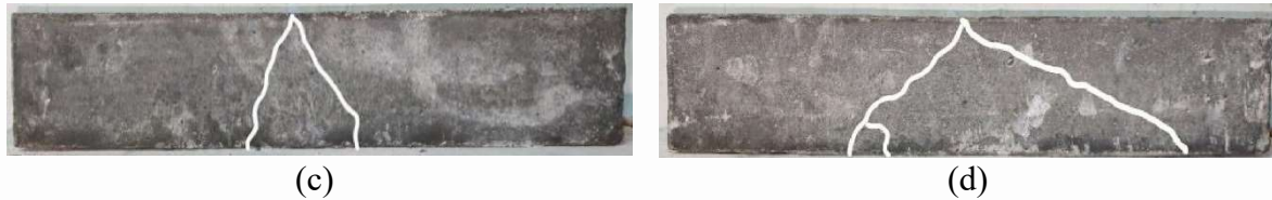
Fig.5 Crack distribution of (a) BW0, (b) BW2, (c) BW4 and (d) BW6
